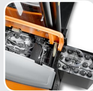
2. Прямоугольный кожух батареи и новое крепление ускоряют работу. Долив дистиллированной воды осуществляется без снятия батареи с машины. Быстрая замена аккумулятора возможна с обеих сторон.
